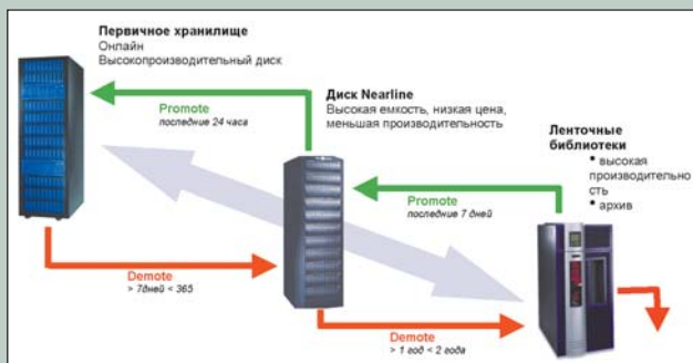
Принцип действия DMF
