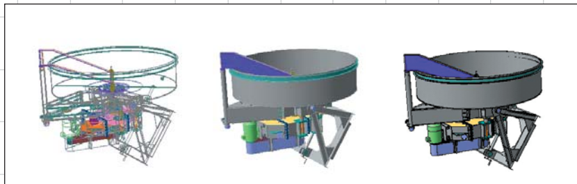
Рис. 2. Каркасный, полутоновый и полутоновый+кар-касный режимы изображения
