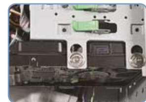
специальные сайлент-блоки обеспечивают низкий уровень вибрации и увеличивают надежность дисковой подсистемы
